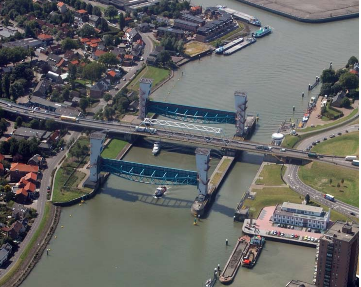
De eerste opgeleverde kering van de Deltawerken: De Hollandse IJsselkering bij Krimpen aan de IJssel.
