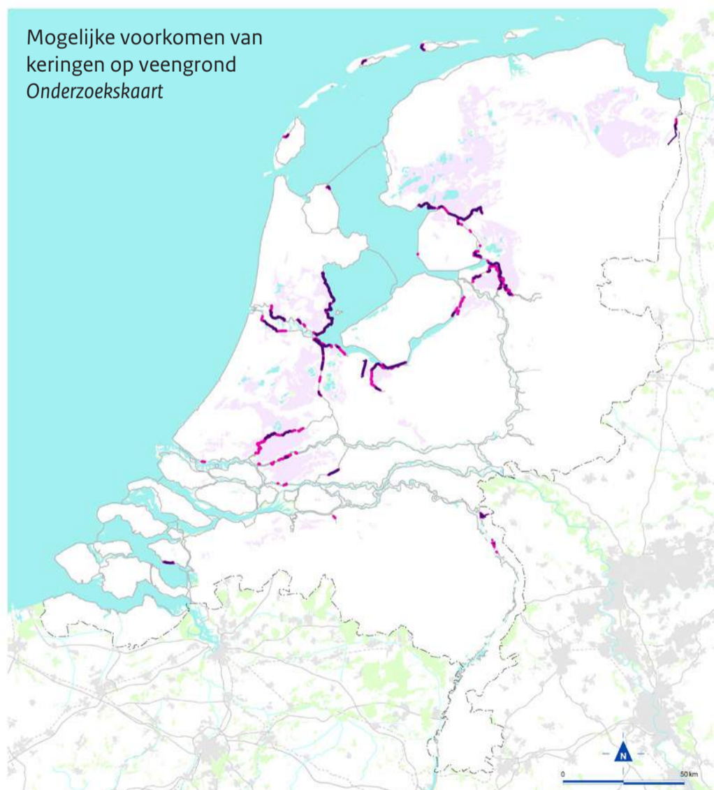
Mogelijk voorkomen van keringen op veengrond ■ veengrond ■ primaire keringen binnen 100m van veenbodem ■ primaire keringen binnen 500m van veenbodem
