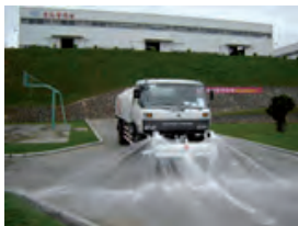
Sproeiwagen voor het wassen en koelen van wegen (bron: tradenote.net)
