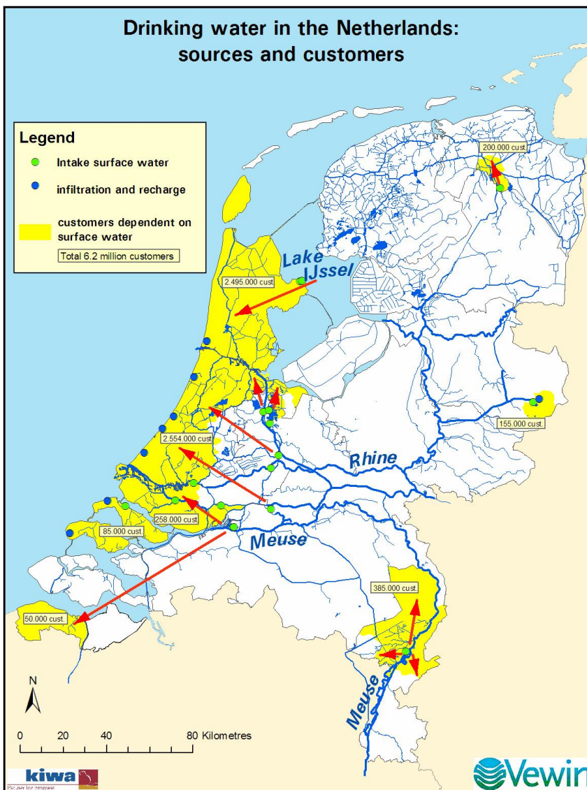
Figuur 3.8 Innamelocaties en voorzieningsgebied van de oppervlaktewaterbedrijven in 2007. Uit het Twentekanaal bij Enschede wordt sinds 2008 geen oppervlaktewater meer onttrokken.
