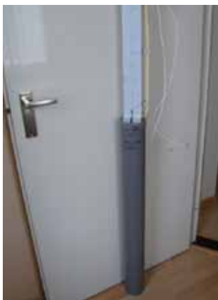
Zelfgemaakte peilbuis met elektronische bewaking van het niveau van het grondwater
