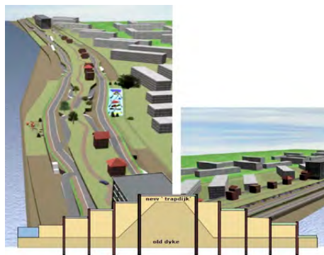
Figuur 10: Trapdijk, Rotterdam
