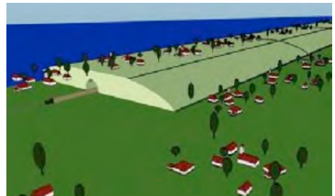
Figuur 27: Ontwerp van een doorbraakvrije dijk
