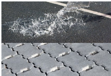
Waterdoorlatend asfalt en bestrating
