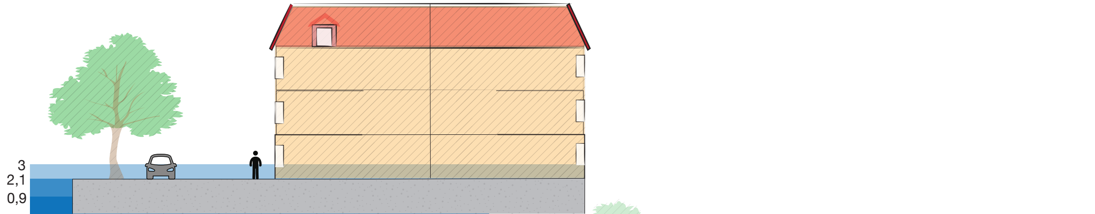
Doorsnede 2: Houwtuinen in verhouding tot maatgevende overstroming.
