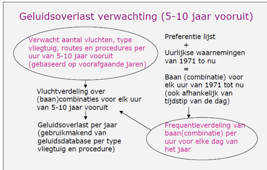
Figuur 3.5c: bepaling geluidbelastingprognose voor 5-10 jaar vooruit met behulp van programma Daisy (stap 4 in de tekst)
