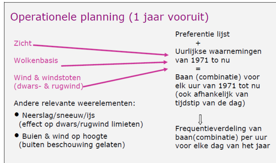
Figuur 3.5a: bepaling frequentieverdeling baancombinaties voor elke dag van het jaar, voor elk uur met behulp van programma Daisy (stap 1 en 2 in de tekst)
