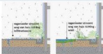
Regenpijp afkoppelen | Amsterdam Rainproof rainproof.nl
